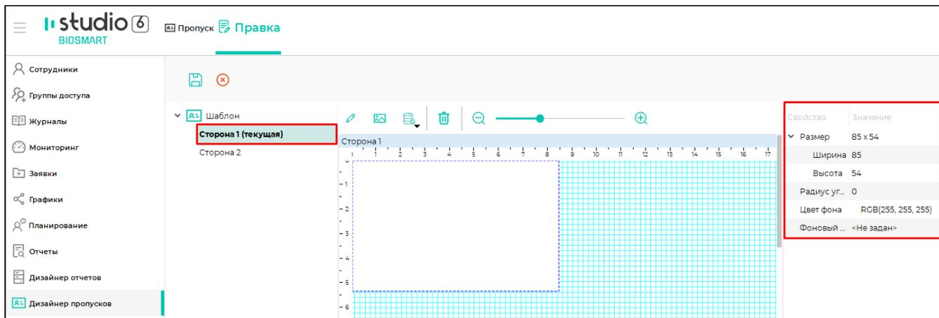
Размер шаблона пропуска определяется значениями **Ширина** и **Высота**, которые задаются в миллиметрах относительно левого верхнего угла.
