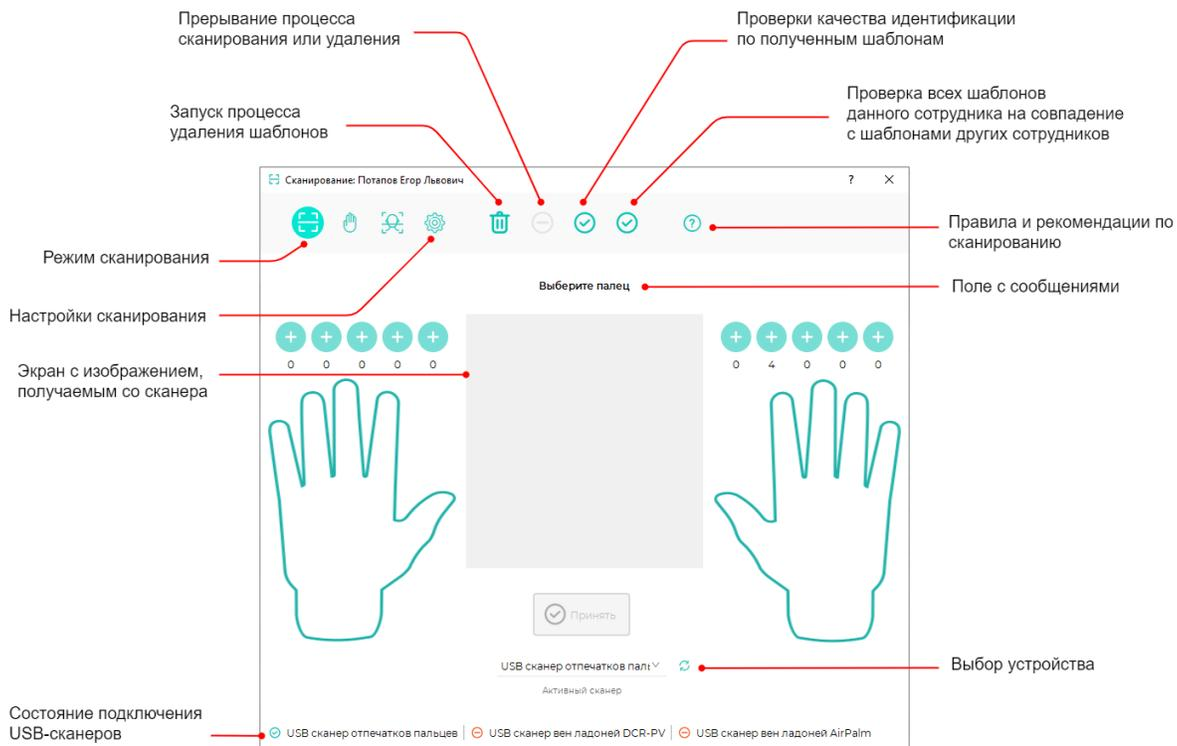
Выберите из выпадающего списка тип устройства, с которого будет производиться регистрация отпечатков пальцев. Такими устройствами могут быть настольные считыватели отпечатков пальцев (USB сканеры отпечатков FS-80) и считыватели контроллеров или терминалов BioSmart.
