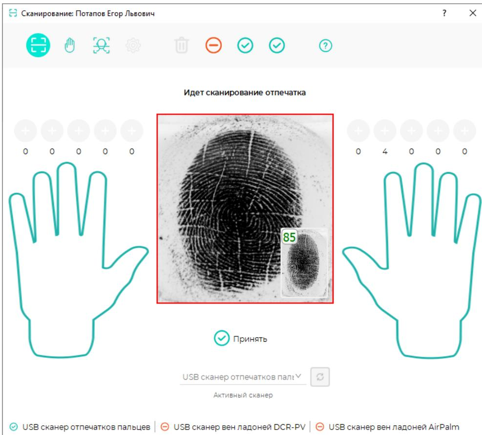
В процессе сканирования на экране с отпечатком могут появиться указания в виде стрелок означающие, что для повышения качества шаблона нужно сдвинуть палец на сканере в указанном стрелкой направлении.
