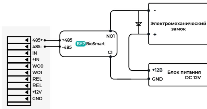
При использовании предложенных схем на БУР BioSmart должна быть снята перемычка X3 (X4), все три адресных переключателя должны находиться в положении Off.
