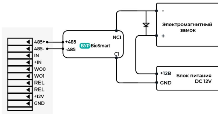
Электромеханический замок подключается через контакты NO и C БУР BioSmart в соответствии со схемой:
