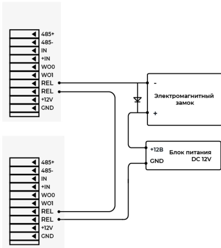
Подключение электромеханического замка к двум терминалам выполняется в соответствии со схемой:
