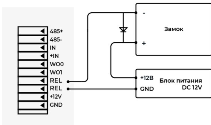
Подключение электромагнитного замка к двум терминалам (с включенной инверсией реле) выполняется в соответствии со схемой:
