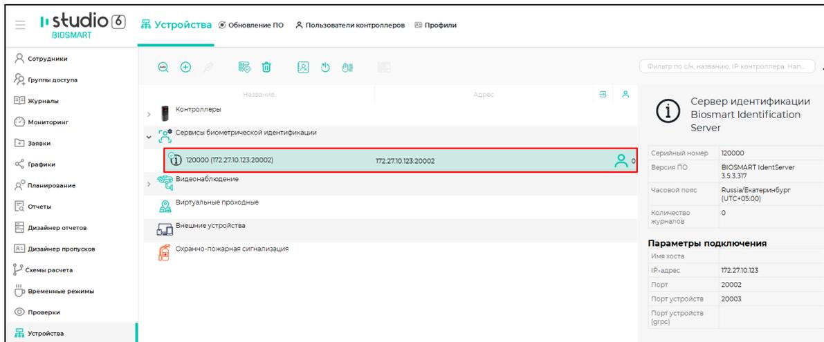
В настройках СИ BioSmart включите функцию **Режим anti-passback** и задайте **Время сброса зоны anti-passback** (интервал времени, в течение которого сотруднику будет запрещен повторный проход в одном направлении).
