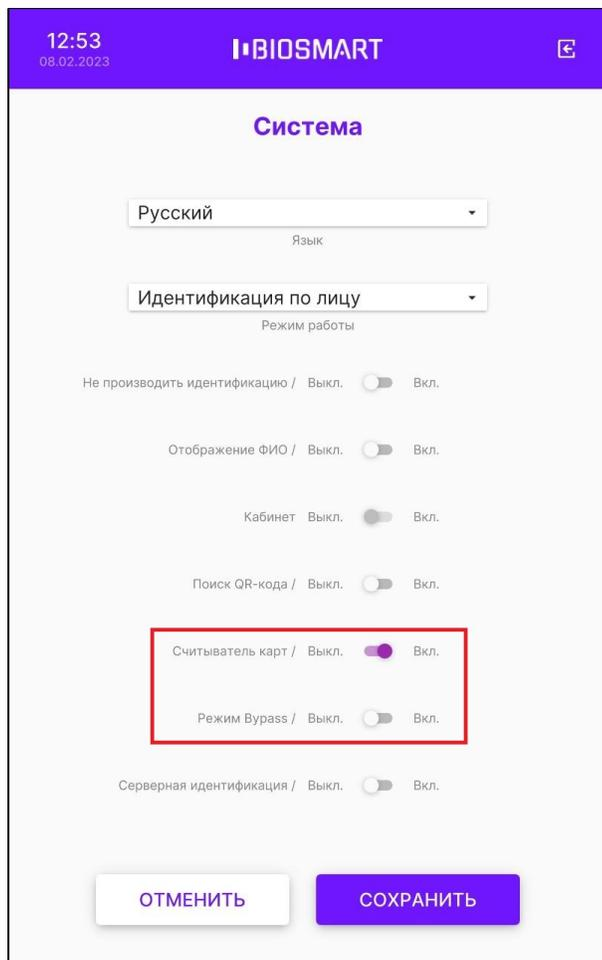
При работе терминала со сторонним контроллером по интерфейсу Wiegand предусмотрен специальный режим Вурасс. В этом режиме считанный код RFID-карты, независимо от того, присутствует он в базе данных или отсутствует, передается на сторонний контроллер через выходной Wiegand-интерфейс терминала. Режим Вурасс используется, когда необходимо обеспечить проход по RFID-картам через стороннюю систему контроля и управления доступом, минуя систему Biosmart.
