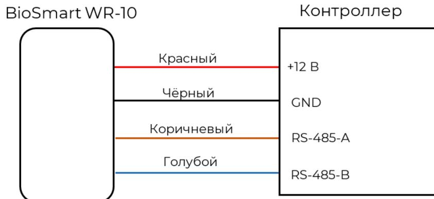
Схема подключения нескольких считывателей к одному контроллеру аналогична схеме подключения считывателей к контроллеру BioSmart Prox-E (см. раздел [Подключение WR-10 к контроллеру Prox-E](#)).
