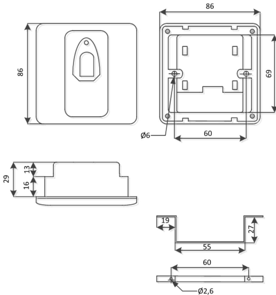
5. Закрепите считыватель с помощью кронштейна, дюбелей и саморезов, входящих в комплект поставки.
