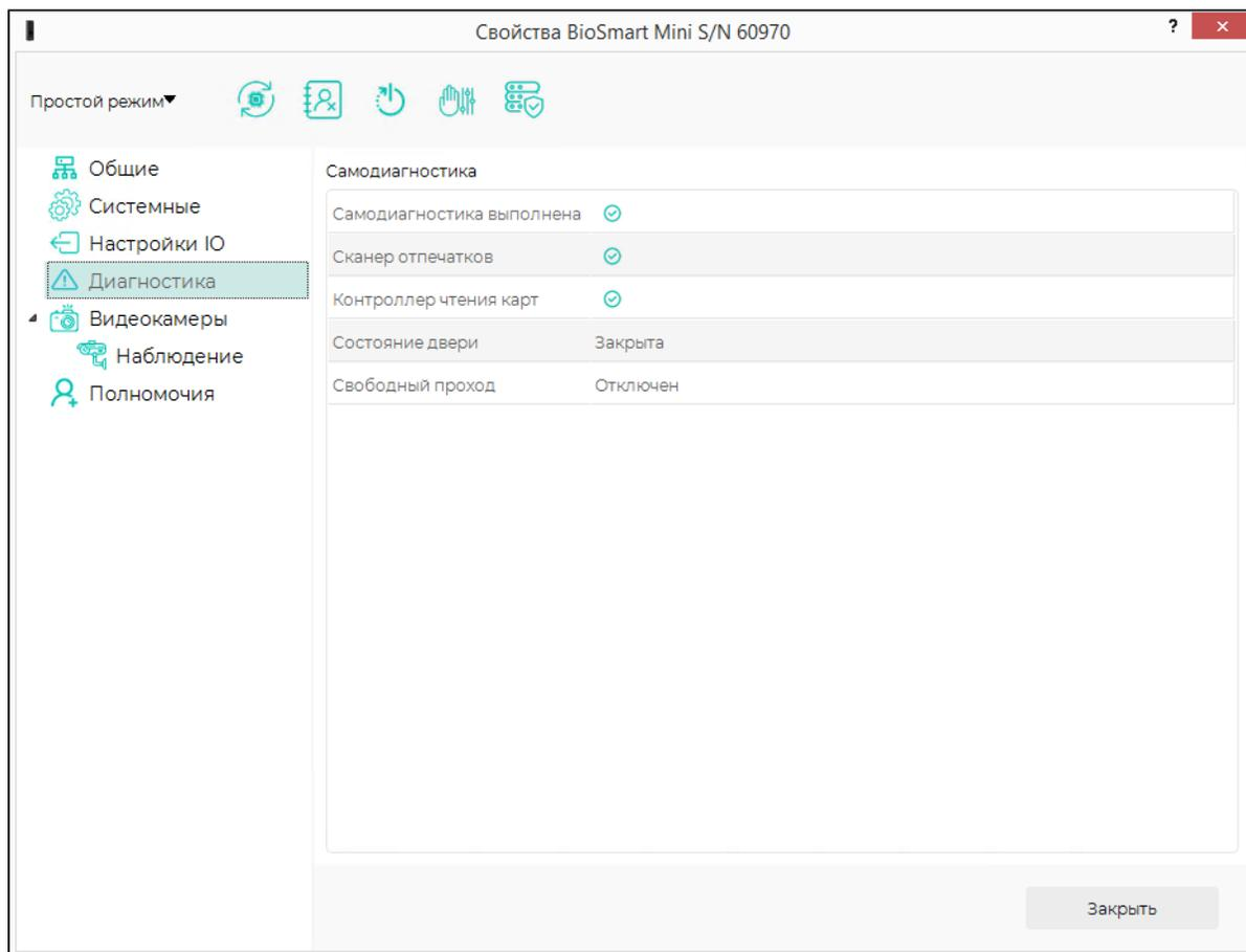
Раздел **Самодиагностика** отображает результаты самодиагностики аппаратных узлов считывателя. При положительном результате самодиагностики должны
