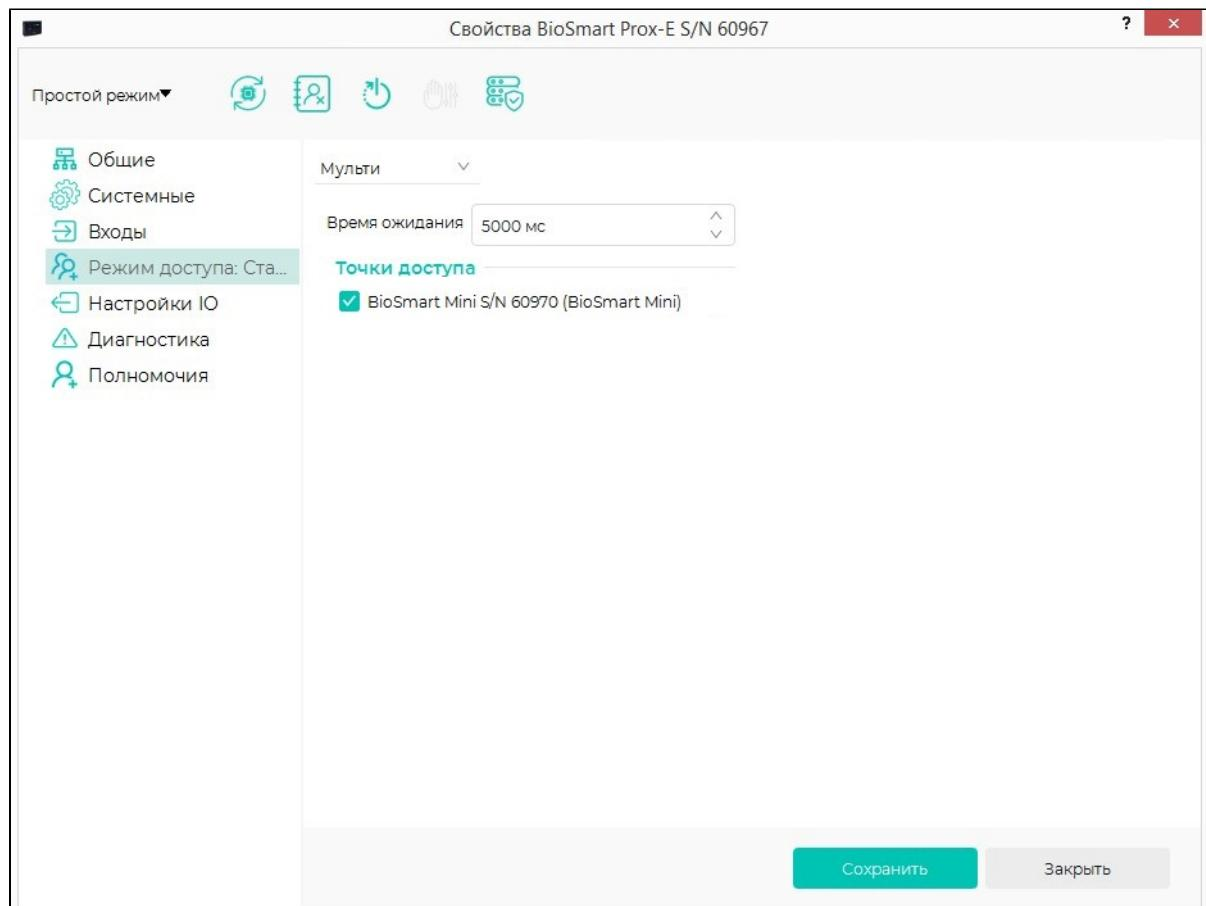
**Шлюз** – организация доступа в проходное помещение, при котором вторая дверь не может быть открыта, пока не закрыта первая дверь.
