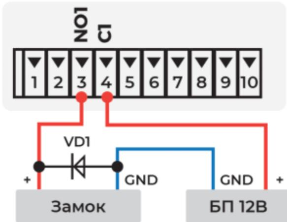
Электромеханический замок без внешнего питания подключается к разъему NO реле 1 или реле 2 и разъему GND в соответствии со схемой ниже.
