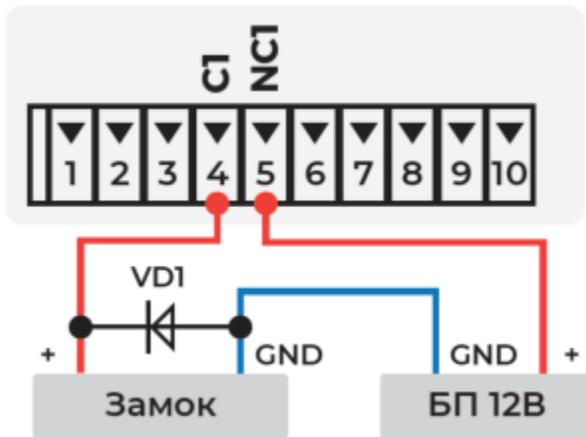
Электромагнитный замок без внешнего питания подключается к разъему NC реле 1 или реле 2 и разъему GND в соответствии со схемой ниже.
