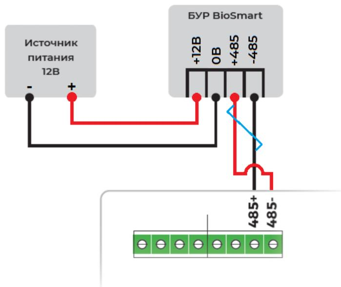
❗ Маркировка на выходах RS-485 контроллера нанесена неверно. Вместо «-» RS-485 должен быть «+», а вместо «+» RS-485 должен быть «-». Схема подключения выполнена с учетом этой ошибки.
