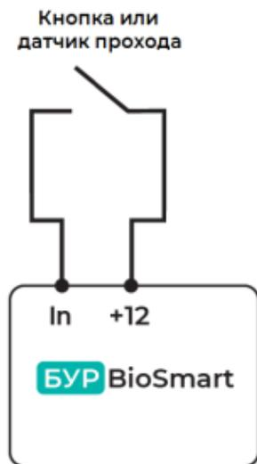
**!** При подключении на вход БУР датчика с открытым коллекторным выходом, необходимо установить подтягивающий резистор номиналом 470 Ом 0,25 Вт между контактами In1 ... In4 и +12. Резистор в комплект поставки не входит.
