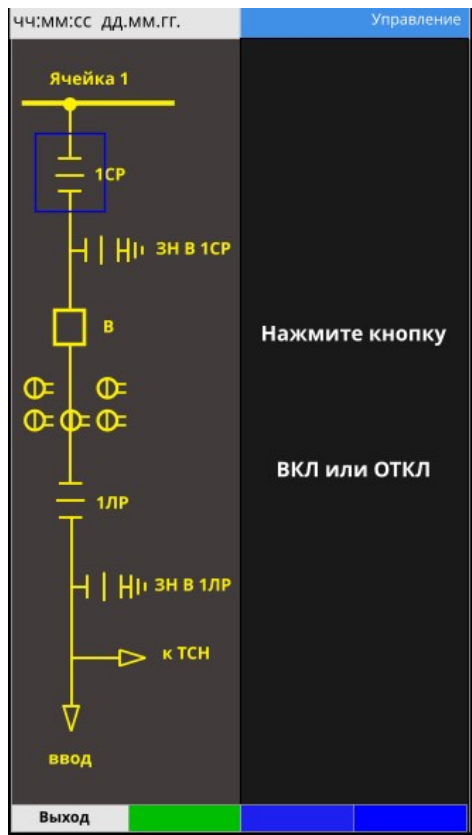
Рисунок 56 – Окно отправки сигнала ТУ «Нажмите кнопку ВКЛ и ОТКЛ»
