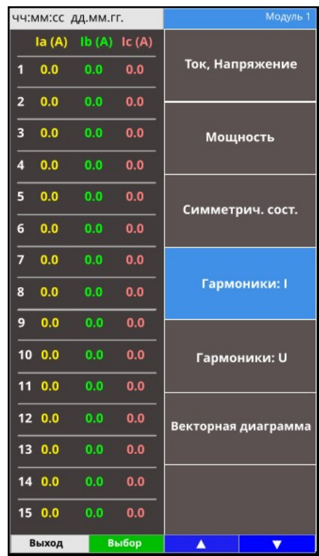
Рисунок 18 – Измерения "Гармонические составляющие тока»
