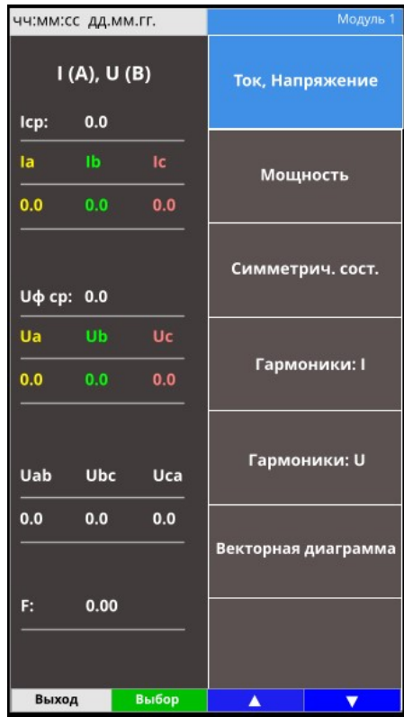
Рисунок 15 – Измерения «Ток, Напряжение»
