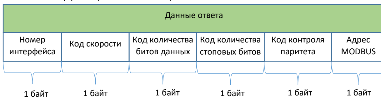
Рисунок 34. Структура ответа на запрос чтения конфигурации интерфейса RS-485
