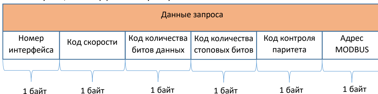
Рисунок 35. Структура запроса записи конфигурации интерфейса RS-485
