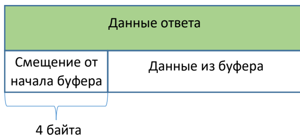
Рисунок 32. Поле данных положительного ответа на запрос чтения данных из буфера сервера
