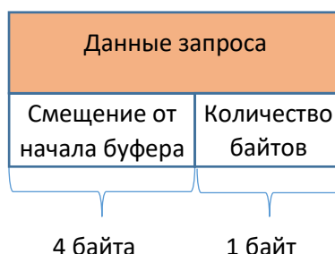
Рисунок 31. Структура запроса чтения данных из буфера сервера
