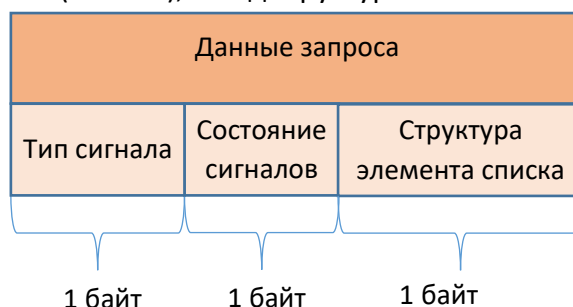
Рисунок 15. Структура запроса списка двоичных сигналов
