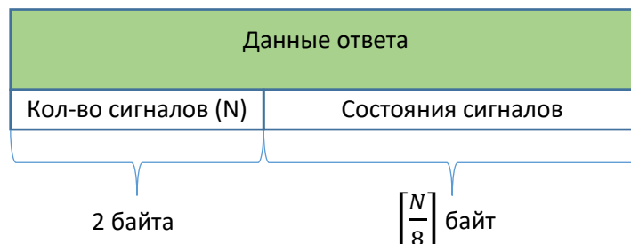
Рисунок 14. Поле данных положительного ответа на запрос чтения состояния двоичных выходных сигналов
