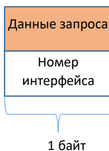
Рисунок 33. Структура запроса чтения конфигурации интерфейса RS-485
