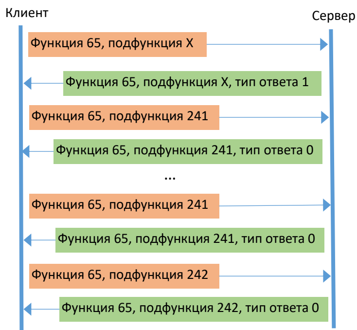
Рисунок 7. Обмен данными при получении длинного ответа
