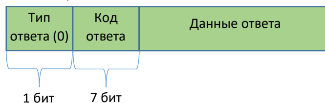
Рисунок 4. Структура поля данных PDU короткого ответа
