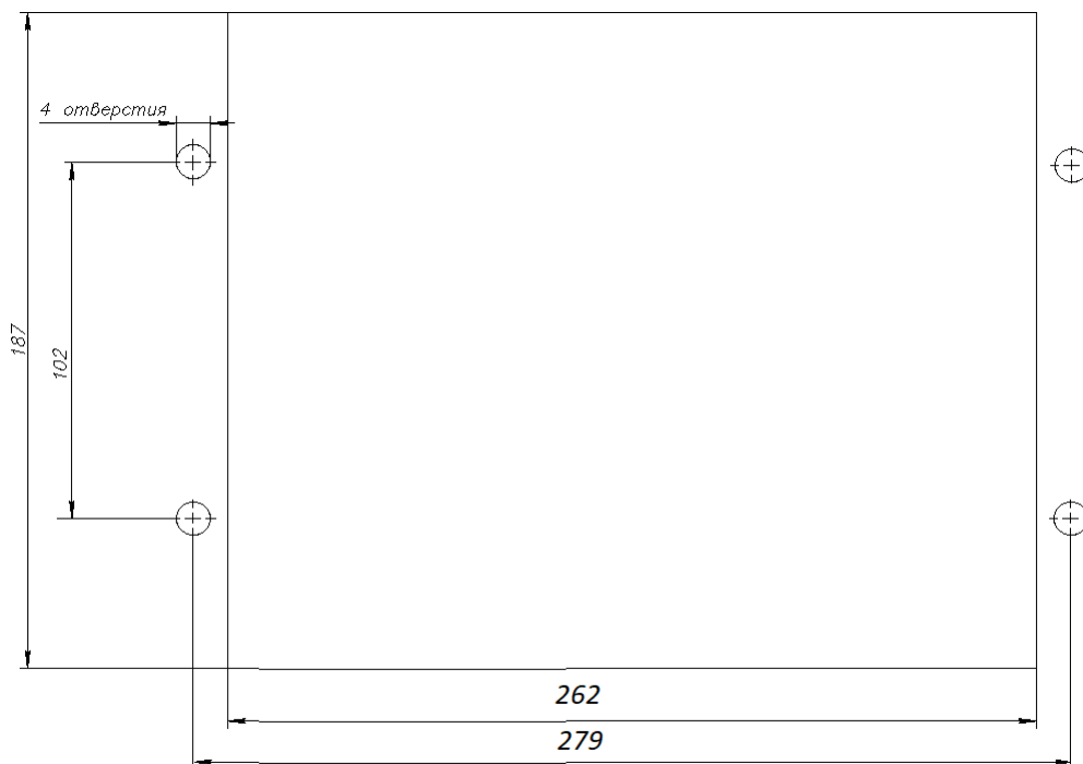
Рисунок Е.13 – Установочные размеры ARIS-2308 со встроенным ИЧМ, мм
