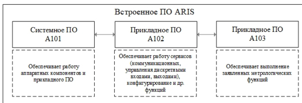
Рисунок 1 – Структура встроенного ПО ARIS
