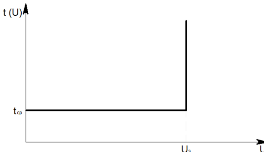
Рисунок 1.3.22.2 - Независимая характеристика времени срабатывания ИО ЗМН
