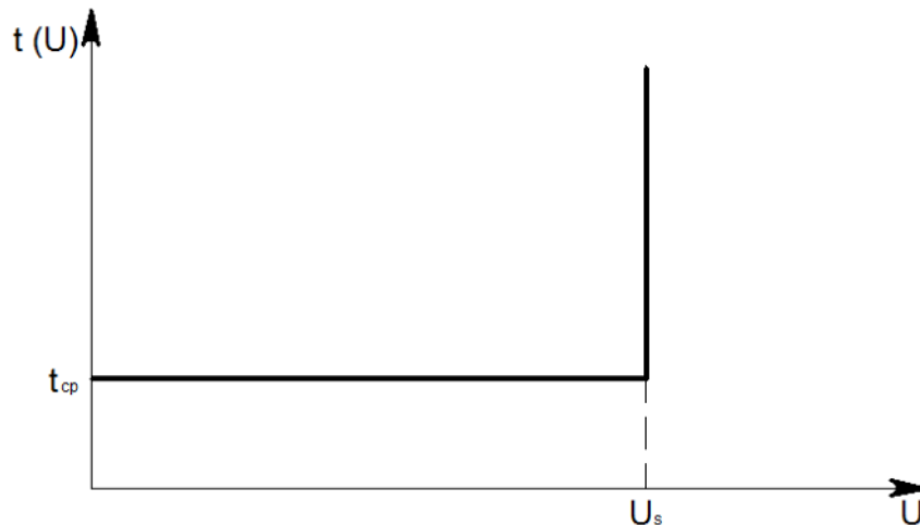
Рисунок 1.3.22.2 – Независимая характеристика времени срабатывания ИО ЗМН
