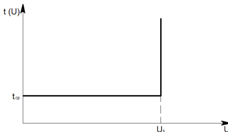
Рисунок 2.2.1.4.2.1 - Независимая характеристика времени срабатывания ИО минимального действия
