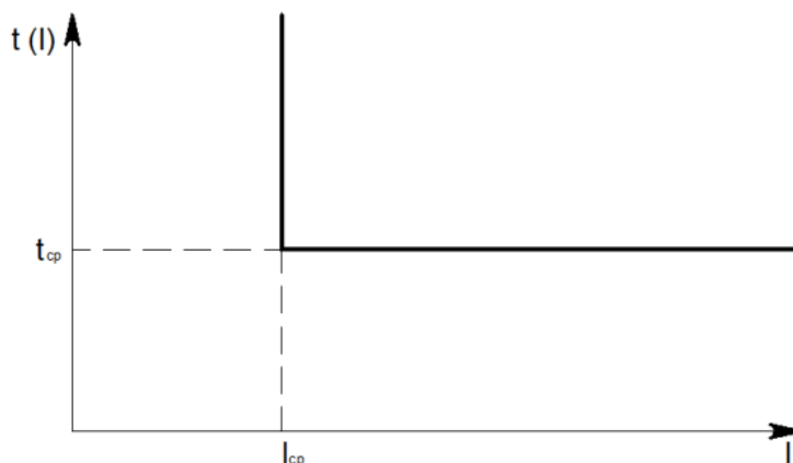
Рисунок 2.2.1.4.1.1 - Независимая характеристика времени срабатывания ИО максимального действия PO_MAX
