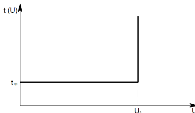
Рисунок 2.2.7.2.1 - Независимая характеристика времени срабатывания ИО минимального действия
