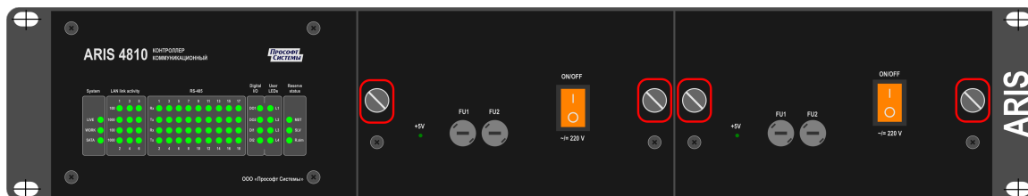
Рисунок 9 – Винты крепления модулей источников питания
