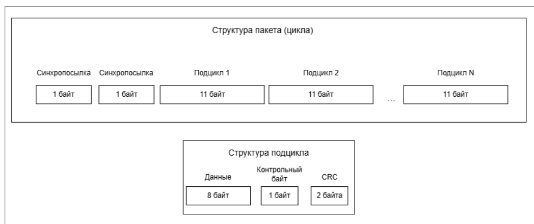
Рисунок 55 – Структура пакета и структура подцикла
