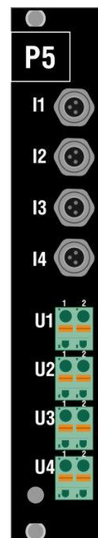
Рисунок 62 – Внешний вид стороны подключения внешних цепей модуля P5.4
