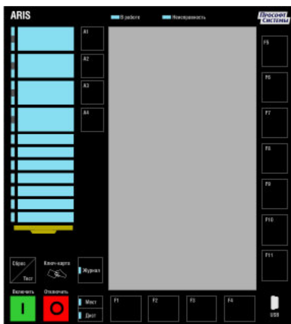
Рисунок 82 – Общий вид НМІ7 типоразмером пять модулей
