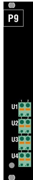
Рисунок 64 – Внешний вид стороны подключения внешних цепей модуля Р9.4
