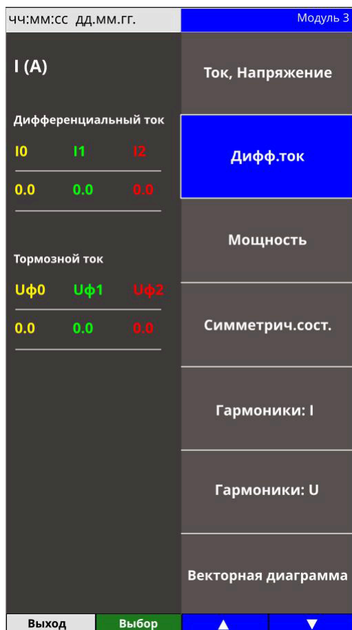
Рисунок 60 – Измерения «Дифф. ток»
