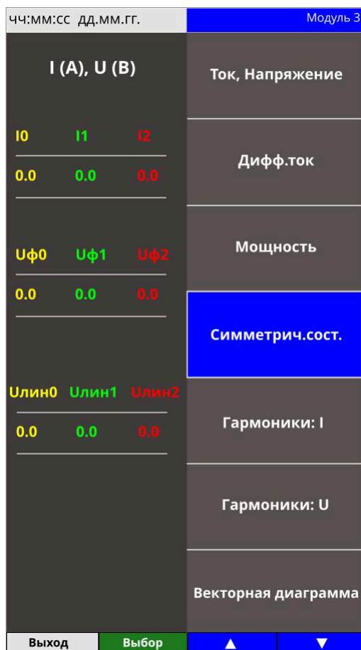
Рисунок 62 – Измерения «Симметричные составляющие»
