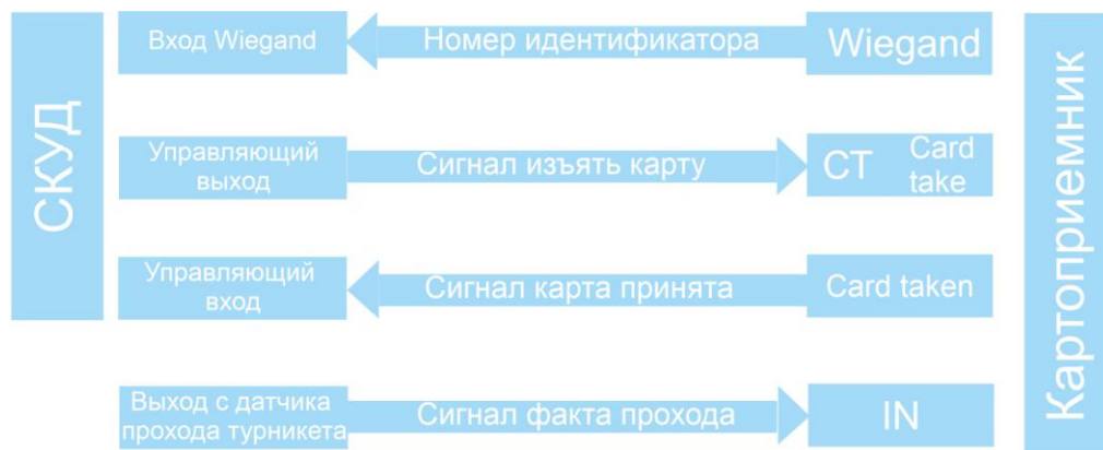
Рисунок 6.2.1 Алгоритм работы картоприемника
