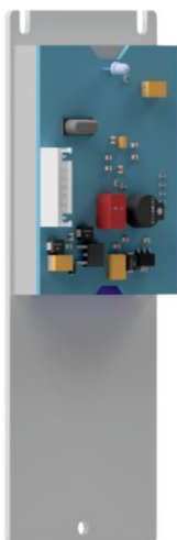
Рисунок 6.3.3 Внешний вид бесконтактного считывателя карт формата Mifare
